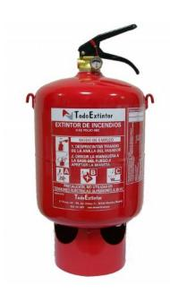
Extintor Automatico de Polvo Quimico ABC de 6 kgs (Sprinkler). Pintado en rojo RAL-3000. Completo. Incluye cadena metálica para su montaje en techo y Rociador instalado con temperatura de disparo estándar (68°C). Fabricado según EN-3. Incluye manómetro externo para comprobación de presión.
