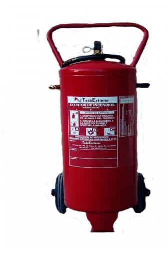
Extintor de Polvo Quimico ABC de 25 kg sobre ruedas. Incluye manómetro, válvula de disparo rápido, chasis tubular soldado al extintor con ruedas y manguera. Pintado en rojo RAL-3000. Fabricado según EN-1866. Diámetro: 800 mm Altura: 900 mm Anchura: 235 mm (350 mm con ruedas). Peso cargado: 42,5 kg Presión de Prueba: 23 Bar.
