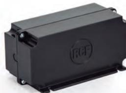
Resonador de 20 Hz, con una impedancia de 200 Ohm a la frecuencia de resonancia. Instalado después del último altavoz, permite supervisar con precisión la integridad de las líneas de altavoces. Adecuado para los sistemas CFVDXT3000 y CFVDXT9000.
