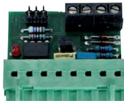
El circuito CFVSI7120 es un módulo del sistema de supervisión del sistema CFVDXT7000. Este supervisa el funcionamiento de las 2 líneas provenientes del sistema de alarma hacia el CFVDXT7000. Si una línea esta abierta o cortocircuitada, el circuito CFVSI7120 detectará la avería y activará una orden.
