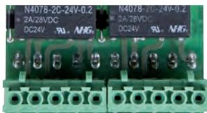
El circuito tiene 2 entradas principales de línea de altavoces de 70-100V, entrada y salida de amplificador de repuesto, 2 relés. El terminal CFVAC7212 debe conectarse directamente a dos salidas de altavoz del CFVLT7208EN. La salida de tensión de anulación del CFVLT7208EN se utiliza para activar el relé del CFVAC7212 en caso de que el amplificador principal esté averiado y así alimentar la línea de altavoces con el amplificador de reserva
