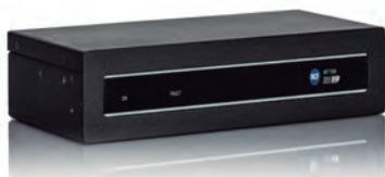
El CFVMT7308 es adecuado para controlar hasta 8 amplificadores de potencia adicionales y sus líneas relevantes de altavoz, de acuerdo con la norma EN 54-16. Este trabaja conectado a la unidad de sistema master CFVMU7100EN. Cuando las líneas de altavoces llevan cargas de alta potencia, puede ser conveniente optimizar la configuración del sistema utilizando uno o más amplificadores de potencia dedicados dimensionándolos según las cargas implicadas.
