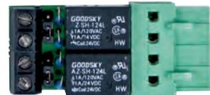
El circuito CFVRO7102 puede conectarse directamente a un par de salidas de control del CFVMU7100EN. Este convierte las salidas CFVMU7100EN de control de colector abierto en 2 contactos secos que pueden usarse como comandos o como dispositivo externo. También dispone de resistencias necesarias para supervisión de líneas de alarma.
