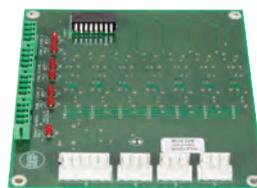
El CFVMG3006 es una tarjeta GPI supervisada adicional para la unidad principal CFVMX3250 (sistema CFVDXT3000). Permite supervisar las entradas de uso general del sistema de emergencia (GPI) y detectar (e informar) cualquier línea abierta o cortocircuito a lo largo de la línea entre CFVDXT3000 y otros dispositivos de alarma, como botones de alarma. El CFVMG3006 está instalado en el interior del cofre CFVMX3250 y alimentado (24V) directamente por el sistema.
