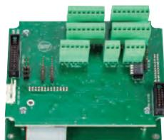
Permite conectar hasta 8 unidades CFVMX3250, en una configuración MASTER / SLAVE. Las unidades del sistema comunican más de 2 conectores Euroblock de ocho pines, con el fin de garantizar una red completamente redundante. También son posibles las llamadas locales para fines que no sean de emergencia.
