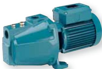
La **bomba jockey** es la encargada de mantener la presión en la instalación y subsanar las pequeñas pérdidas por fugas o goteos que eventualmente se produjeran en la instalación. Las maniobras de arranque y paro de esta bomba se realizan a través de un presostato.
