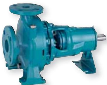
Bombas en ejecución normalizada según EN733, en versión eje libre. Acopladas a motor eléctrico o diésel mediante acoplamiento que permita su reparación y mantenimiento sin que sea preciso desmontarla ni desmontar el motor. Disponen de rodete fabricado en bronce fundido en una sola pieza. Sellado mediante empaquetadura, no siendo posible realizarlo con cierre mecánico.
